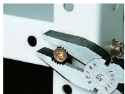
プライヤーと同じくわえ部で、ボルトやナット、パイプ類をくわえ回すのに便利。
